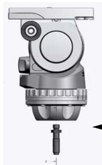
Um den FSB 8 mit Flachbodenanschluss verwenden zu können, muß der Gewindezapfen entfernt werden.
